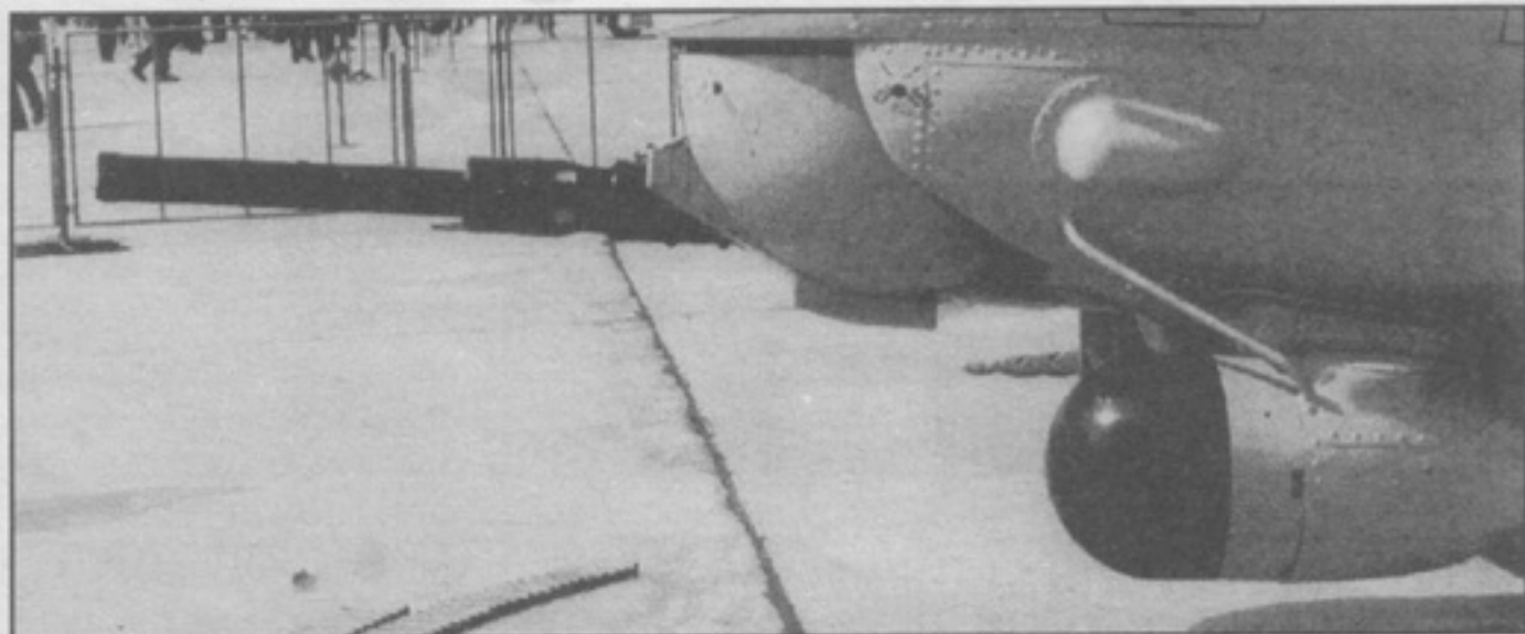
■ 12,7-мм четырехствольный пулемет ЯкБ на вертолете Ми-24
